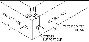
STEP 1 - CORNER SUPPORT CLIPS LOCATE AND FASTEN GALVANIZED CORNER SUPPORT CLIPS TO THE WALL. FASTEN THRU FACE IF OUTSIDE FACE IS OVER 6".
